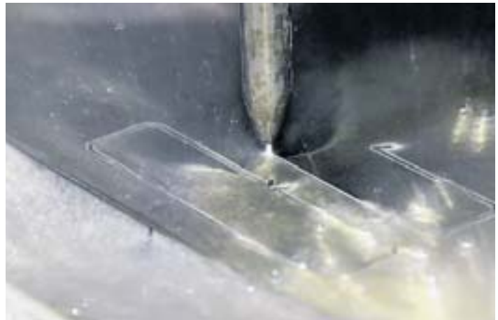
Haargenaue Schnitte sind mit normalem Wasser möglich. Foto: Andreas Fischer
